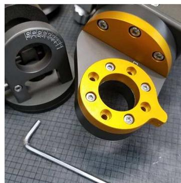
6. 高度部を分解した図です。実際には高度ユニットを引き抜かず金具の角度を調整できます。5で取り外した2本のネジ穴に合うように金具を回転させて再度固定してください。
