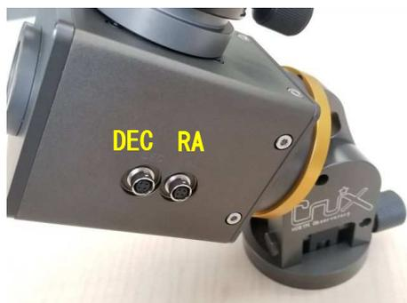
3. TitaN TCSコントローラーと接続するモーターケーブルはRA／DECをご確認の上、接続してください。ケーブルには各軸のシールが貼られております。TitaN TCSと表記されている場合はTitaN TCS側の接続となりますのでご注意ください。
