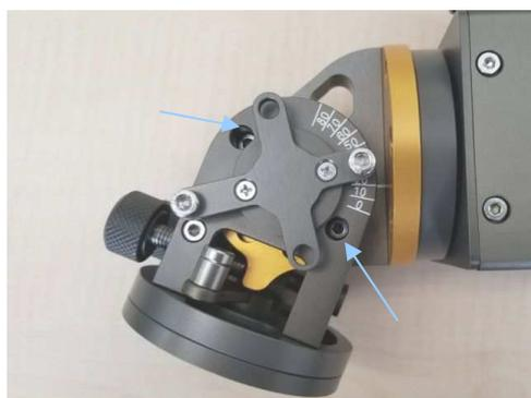
5. 高度の利用可能範囲を変更する場合は写真の2箇所のネジを取り外します。ネジ穴をあわせて六角レンチで緩めましょう。
