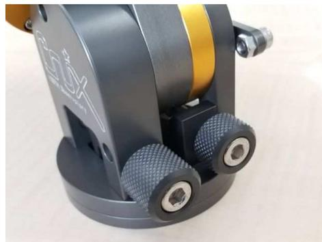
2. 方位角／高度調整ハンドルを使って極軸が北極星を向くようにします。この時側面の高度表示目盛りを利用して、観測場所の緯度と一致させましょう。角ハンドルは六角レンチを使って操作することも可能です。調整が完了したら各クランプを締めて固定しましょう。
